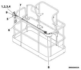
Figure 27. Bolt-On External Fall Arrest System
